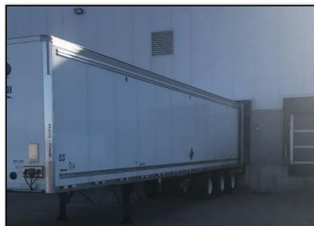
**Figure 218.1** Quai de déchargement hermétique permettant à la manipulation de matériau de ne pas être exposée aux intempéries
