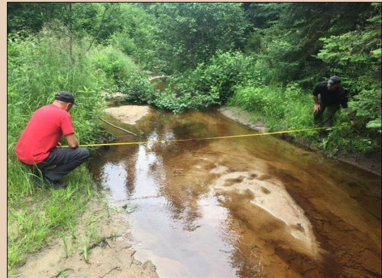
Annexe 9 (5) Correspond à la pente du cours d'eau mesurée entre deux seuils naturels non touchés par les travaux et situés en amont à une distance équivalant à 2 fois la longueur du conduit.
