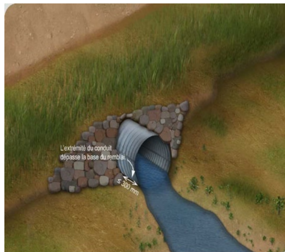
Dépassement maximum du ponceau par rapport au remblai (MFFP RADF)
