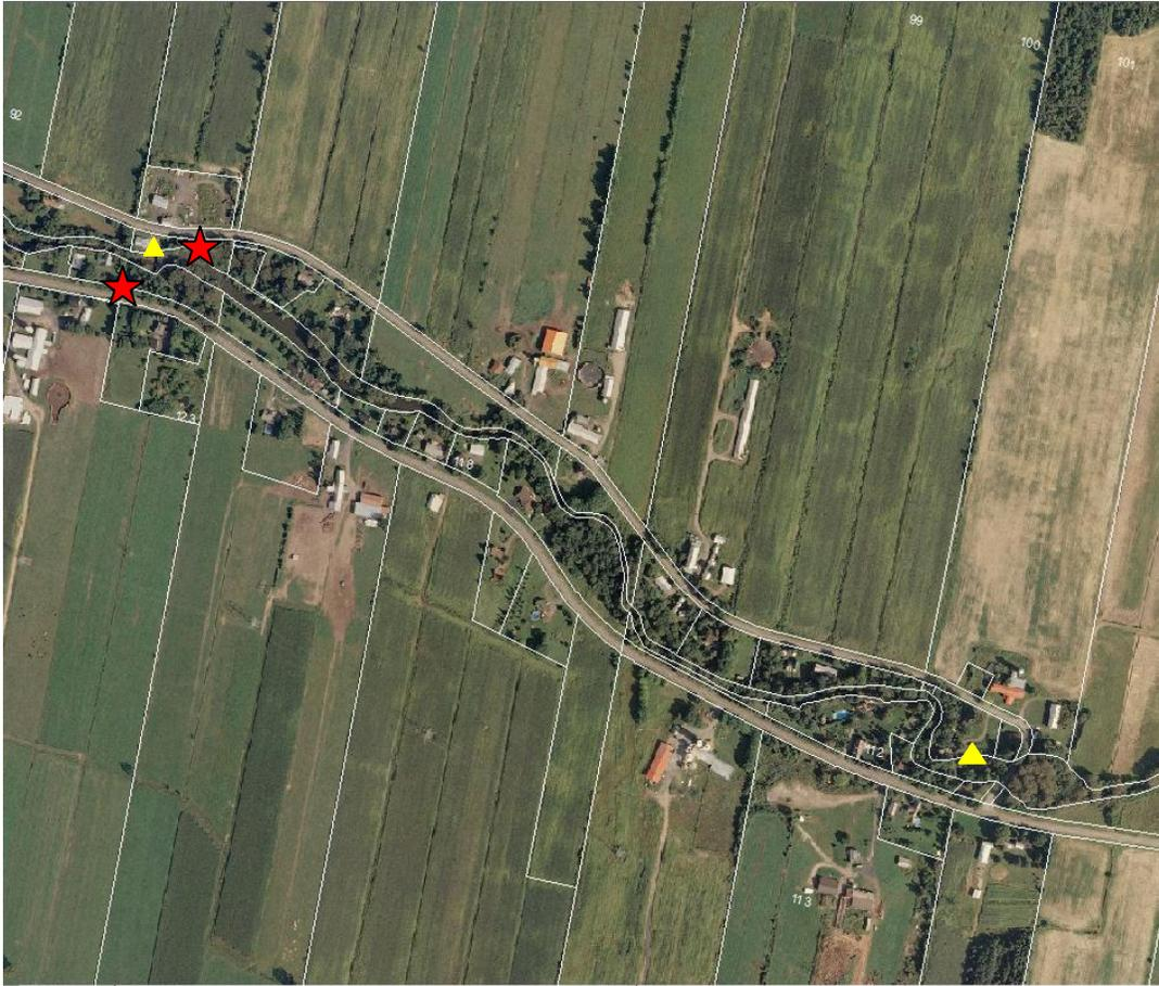
Figure 1. Vue arienne du cours d'eau Grande Décharge. Les barrages de faible contenance sont identifiés en jaune. Les zones inondées sont illustrées par une étoile rouge.
